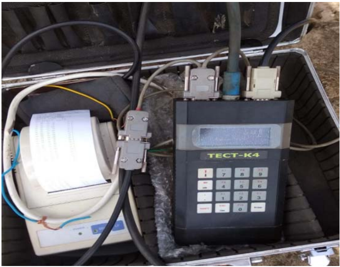
Рисунок 3 - Испытание грунтов статическим зондированием. Комплект аппаратуры ТЕСТ-K4М
